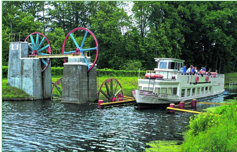
Seilzugvorrichtung am Oberlandkanal auf dem Schiffe über schiefe Ebenen den Höhenunterschied überwinden. Foto: Poln. Fremdenverkehrsamt
